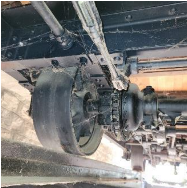
Roue plate véhicule gare aval
